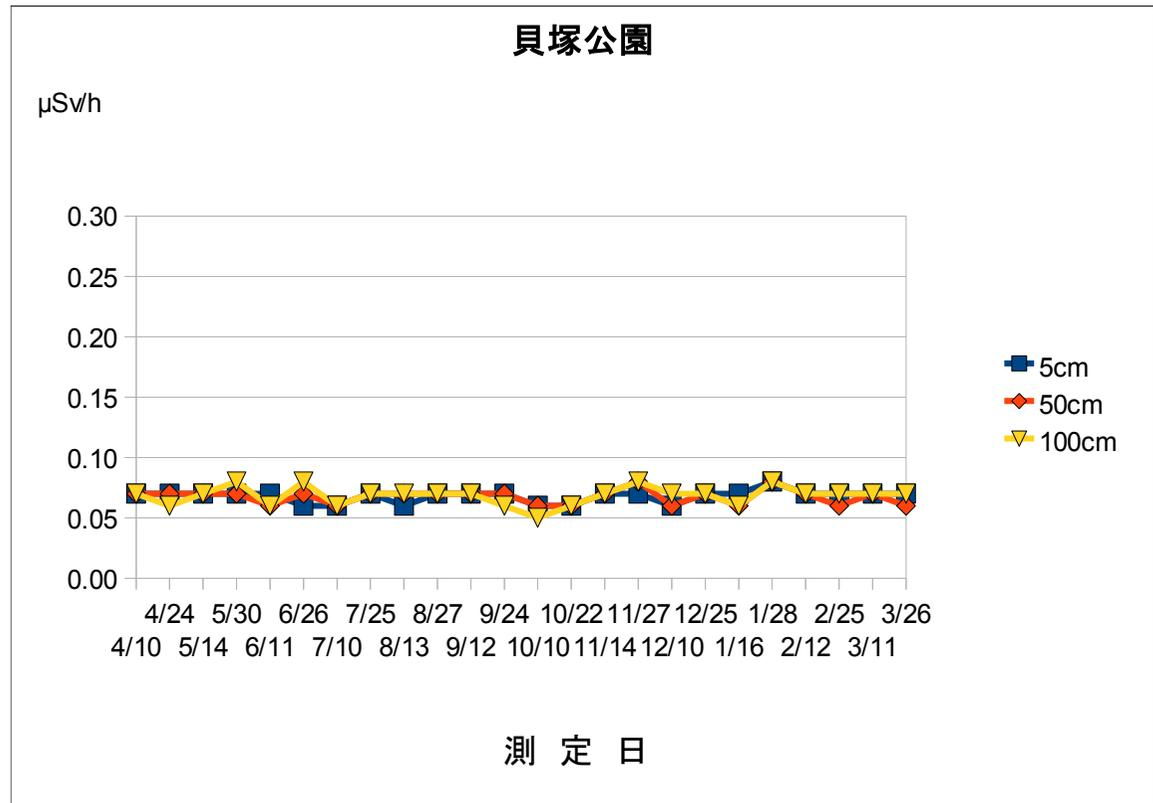
測定は、NaIシンチレーション式サーベイメータ（日立アロカ社製：TCS-172B）を使用しています。
