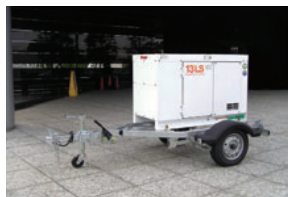
写真5 移動式発電装置
